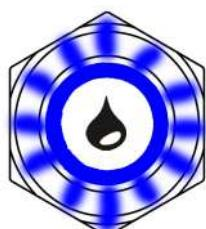
Der Taster der WTE blinkt nach einem Neustart der Behandlungseinheit rot-blau. DK-DOX 150 muss nachgefüllt werden!
