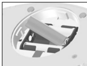
Positionieren Sie den roten Faden vor dem Einlegen der Batterie.
