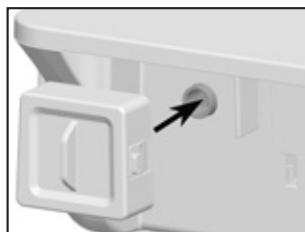
① Stecken Sie den CAN-Dongle an.
